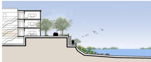
图 7-13 原有直立挡墙改造后
