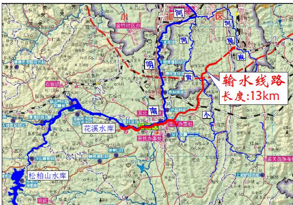
图 5-13 花溪水库-小黄河-麻堤河连通工程布置示意图
